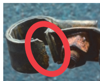
腐食で割れたターミナル
